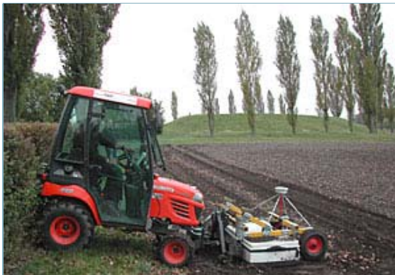
Die Entdeckung gelang mit einem neuen motorisierten Multikanal-Bodenradargerät.
